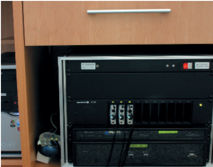
AKUSTICARE-Einheit im Lehrerpult mit Steuerzentrale MCS 50, Empfänger NE 500 S, Festsender CT316 und Akkuladegerät LG30 für die UHF-Taschenempfänger FE316 von beyerdynamic
